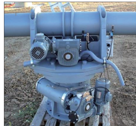
Obr. 1. Typizovaný rozváděč pro řízení dvuosého polohovacího zařízení s instalovanými PLC AC500 a měniči frekvence – ACS350 (vlevo), pohonná jednotka OEM s motory ABB (vpravo)
