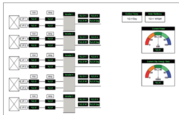
Obr. 3. Integrace informací ze střídačů a z atmosférického i energetického měření (vlevo); snímek z vizualizace (vpravo)
