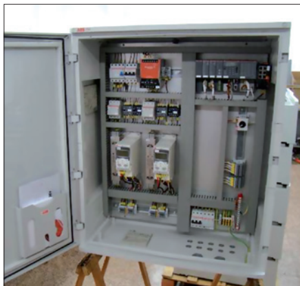
Obr. 1. Typizovaný rozváděč pro řízení dvuosého polohovacího zařízení s instalovanými PLC AC500 a měniči frekvence – ACS350 (vlevo), pohonná jednotka OEM s motory ABB (vpravo)
