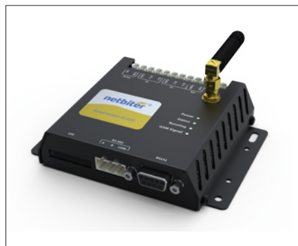
Obr. 1. Jednotka sběru informací Netbiter Easy Connect
