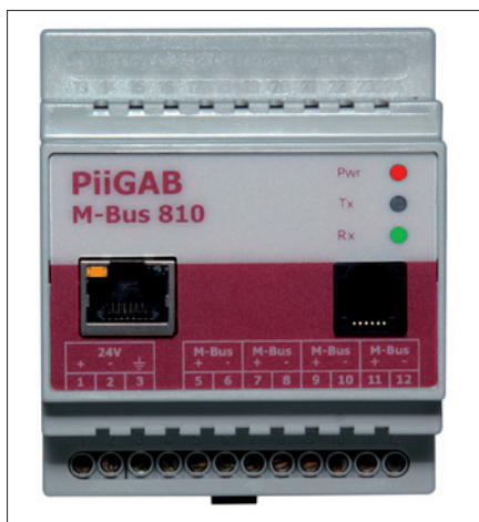
Obr. 1. Převodník M-Bus – LAN umožní odečít spotřeby přes internet
