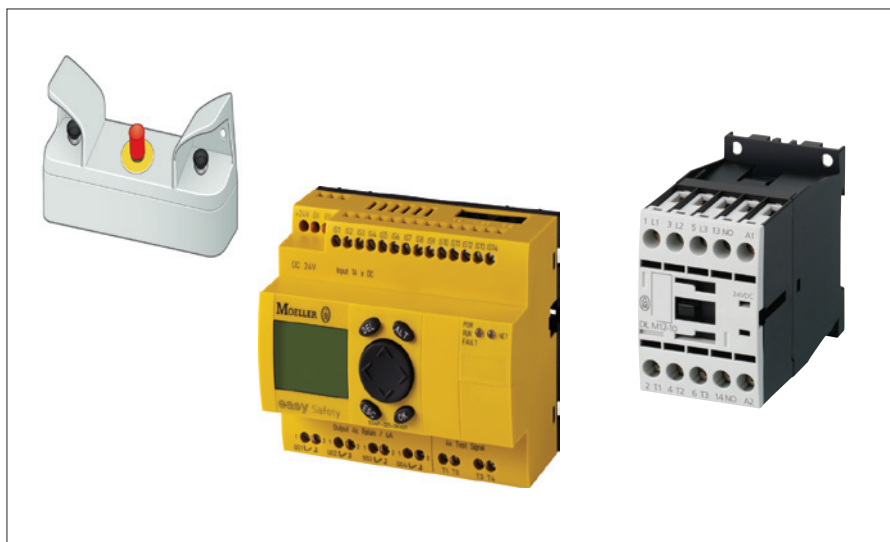
Obr. 3. Přístroje použité pro funkci dvouručního ovládání; zleva hřibová tlačítka v modulu dvouručního ovládání podle ČSN EN 574 M22-DP-Y + M22-AK11, bezpečnostní řídicí relé easySafety ES4P-221-DMXD1, stykače DILM12
