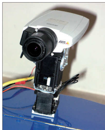
Obr. 6. Použití pohonnů v mechanismu dálkového - teleprezenčního ovládní kamery
