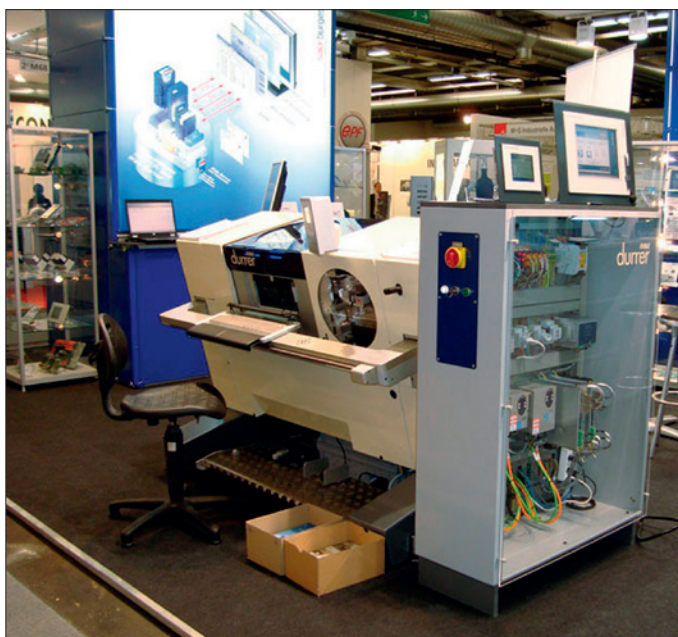
Obr. 1. Nové moduly řady H se s výhodou uplatní ve stroji pro zpracování post-tiskových výstupů (foto: Durrer Special machines Ltd.)
