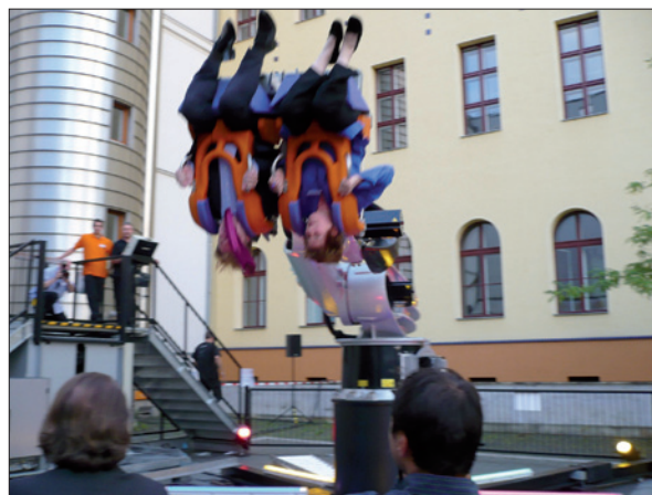
Obr. 2. Robocoaster, průmyslový robot firmy KUKA pro zábavní účely, který má licenci pro přepravu cestujících
