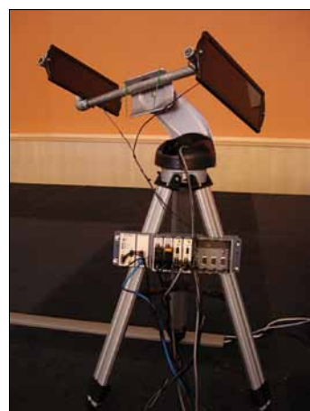
Obr. 1. Na konferenci NI Energy Forum byla demonstrována činnost zařízení k natáčení fotovoltaických panelů podle polohy slunce
