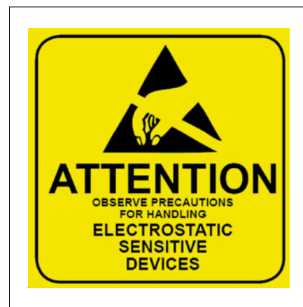
Obr. 1. Symbol upozorňující na potřebu používat opatření pro zacházení s elektrostaticky citlivými součástkami
