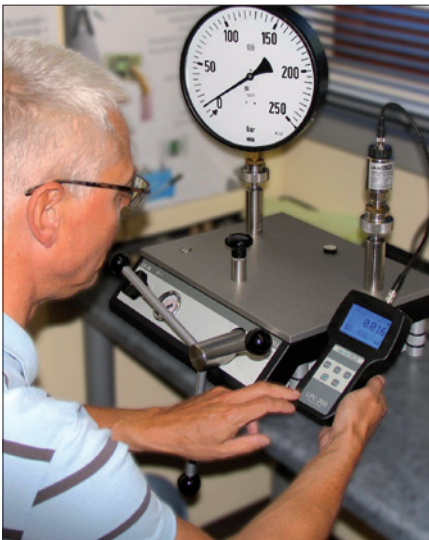
Obr. 1. Práce s etalonovým tlakoměrem LPC 200
