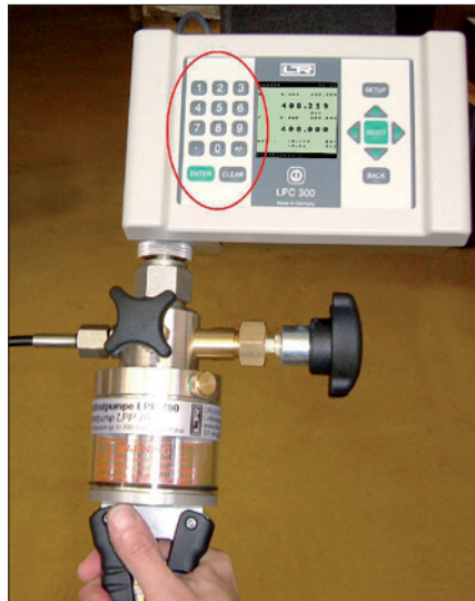
Obr. 2. Kalibrátor tlaku LPC 300 namontovaný na kleštvé kalibrační pumpě LPP 700
