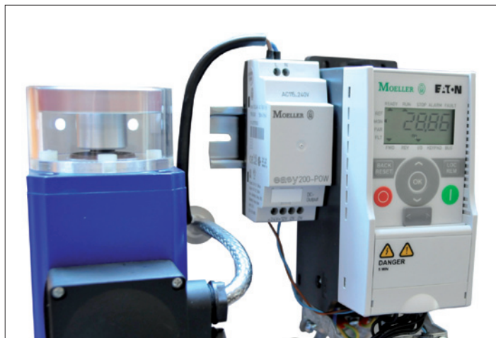
Obr. 1. Ukázka připojeného měniče frekvence M-Max k třífázovému asynchronnímu motoru
