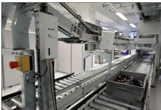
Obr. 1. Systém RFID BIS U od firmy Balluff pracuje v pásmu UHF a je vhodný do průmyslových podmínek (foto Balluff)
