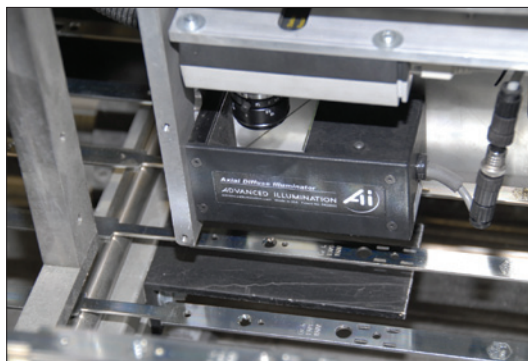
Obr. 1. Součástka (na obrázku dole) musí postupovat ke zpracování správnou stranou vzhůru - její poloha je kontrolována kamerou Cognex DVT 510 s difúzním osvětlovačem
