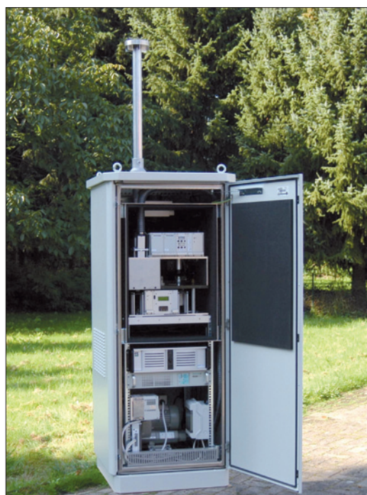
Obr. 1. Moderní monitorovací stanice zcela automaticky zjišťuje množství pylových částic v ovzduší (foto: Fraunhofer FIT)
