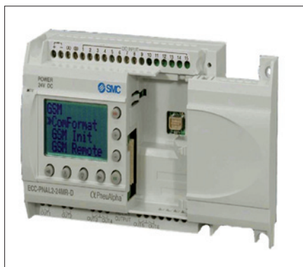
Obr. 1. Programovatelný automat PneuAlpha2 pro jednoduché řídicí úlohy
