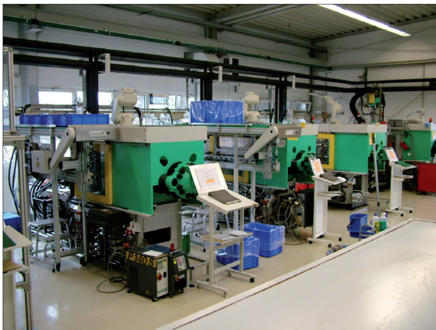
Obr. 1. Pohled do dílny se vstřikovacími lisů obsluhovanými průmyslovými roboty
