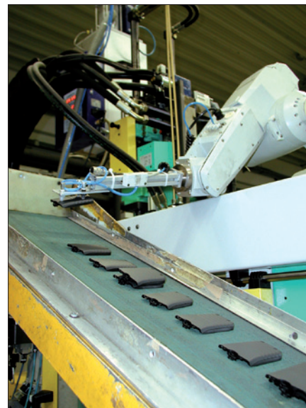
Obr. 2. Průmyslový robot Mitsubishi RV-6S vyjímá výlisky z formy a odkládá je na dopravník
