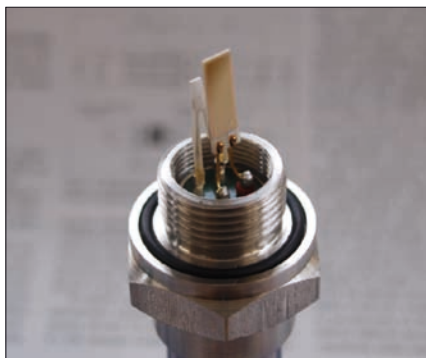
Obr. 10. Sonda k měření relativní vlhkosti a teploty HTP-7712... se senzory FE 09/1000 a Pt10000
