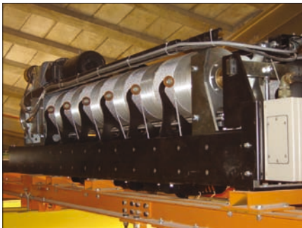
Obr. 4. Moderní kompaktní stavebnicový pohon tahu typové řady BT2-390 s asynchronním motorem a měničem frekvence (zdroj: Stage Technologies)
