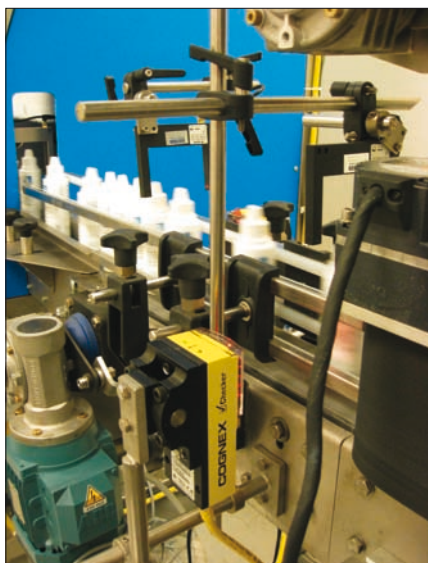
Obr. 1. Snímač Cognex Checker kontroluje, jestli mají všechny lahvičky na dně natištěn výrobní kód a nalepenou správnou etiketu.
