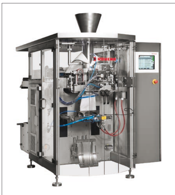
Obr. 1. Balicí stroj od firmy Rovema využívá Sercos III
