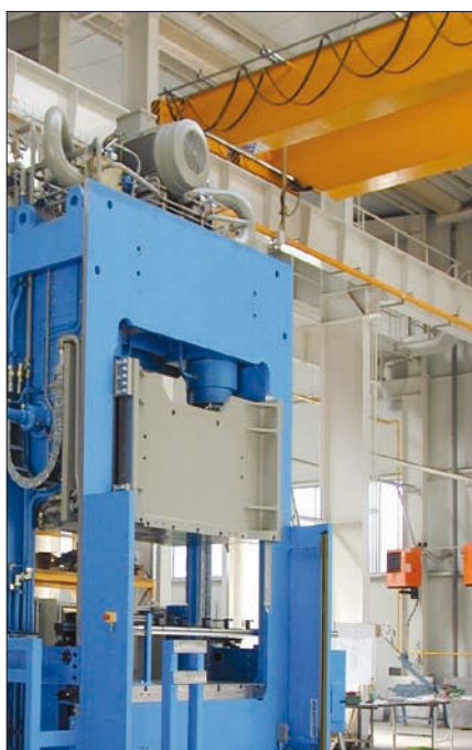
Obr. 2. Pohony lis s elektronickou regulací paralelního chodu beranu
