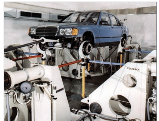
Obr. 5. Měření spolehlivosti a životnosti osobního automobilu na dvanáctikanálovém elektrohydraulickém zkušebním systému
