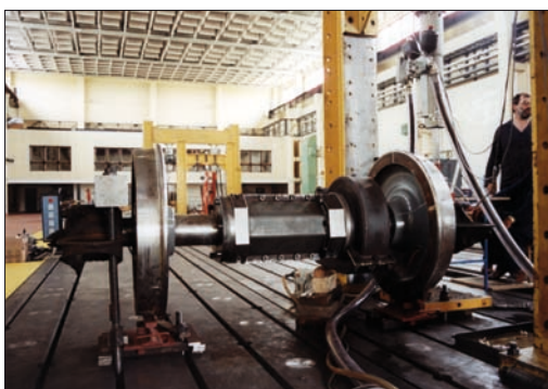
Obr. 3. Silové působení mezi kolejovým vozidlem a tratí za jízdy se měří s použitím měrných dvojkolí; obrázek ukazuje cejchování měrného dvojkolí pro motorový železniční vůz
