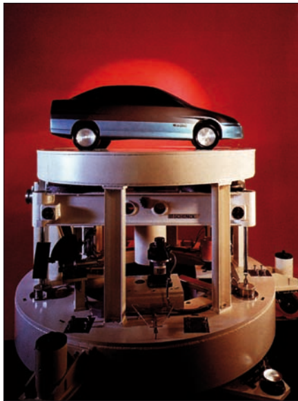
Obr. 1. Šestikomponentní váhy měří v aerodynamickém tunelu v toku proudícího vzduchu velmi přesně síly a momenty působící na modely či reálné automobily nebo letadla
