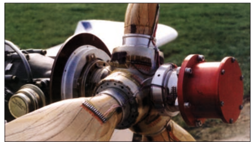
Obr. 2. Přenos měřících signálů z tenzometrů přilepených na listech vrtule s použitím sběrných kroužků
