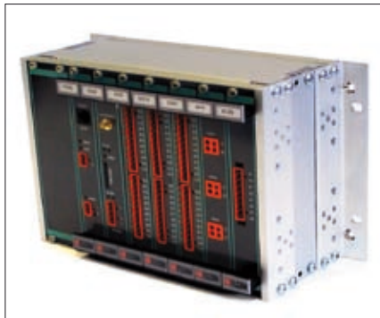
Obr. 1. Modulární řídicí jednotka RTU7M
