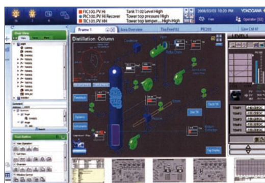
Obr. 4. Systém Centum VP HMI se vyznačuje jednotným a přehledným pracovním prostředím
