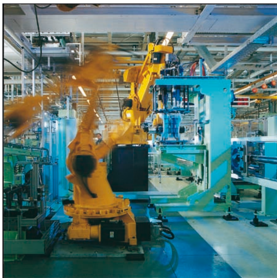
Obr. 4. V mnoha automatizačních úlohách je důležité hledisko bezpečnosti; moderní PLC nyní nabízí integrované pojetí bezpečnosti, tj. kombinaci bezpečnostní a standardní automatizační techniky v podobě jednoho transparentního celku
