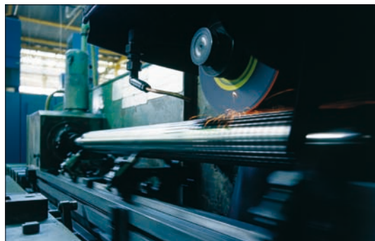
Obr. 2. Řezání drážek v ozubených kolech
