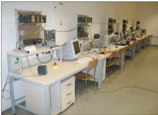
Obr. 1. Celkový pohled na část laboratoře s pracovišti s PLC Simatic S7-300/200 s komunikačními sítěmi Profibus-DP a Profinet
