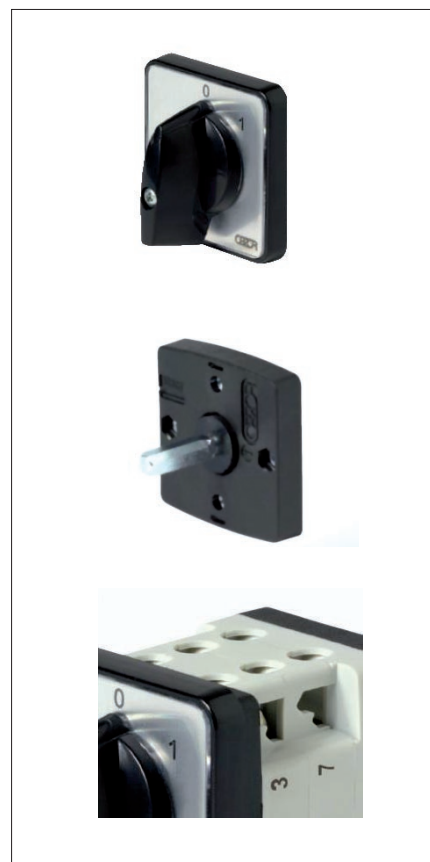
Obr. 2. Nová čelní deska, zatěsnění hřídele pro krytí z čela IP65, základní krytí spínače IP20, pro VSN 10-16-20 přístup ke svorkám pod úhlem 45°
