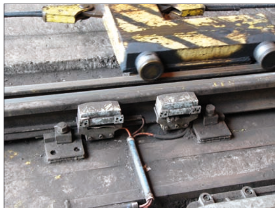
Obr. 3. Snímače polohy kola vagonu
