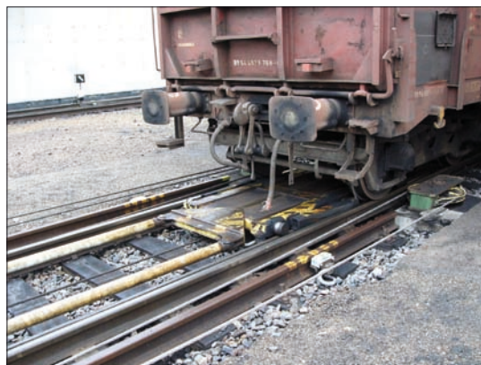
Obr. 2. Vozík lanového posunu posouvá vagon do výklopníku
