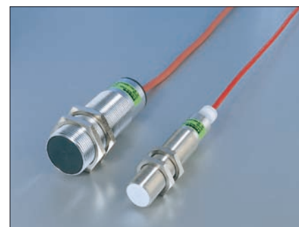
Obr. 7. Při řízení výklopníku jsou využívány signály z indukčních senzorů aprox, které pracují se soustavou tří cívek bez feritového jádra
