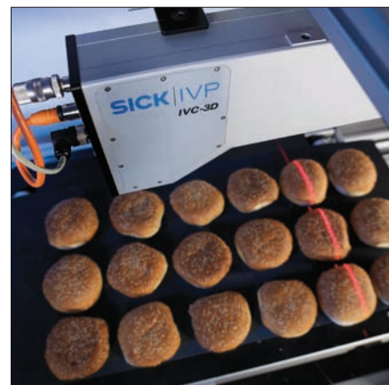
Obr. 3. Kontrola hamburgerových housek – velikost, objem a počet sezamových zrníček
