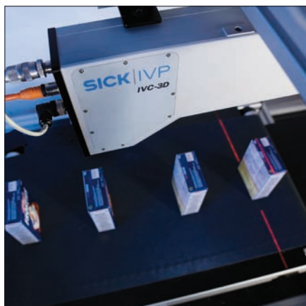
Obr. 2. Kontrola balení potravinářských výrobků
