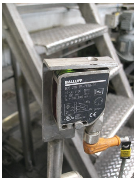
Obr. 2. Optický snímač BOS 21M s celkovým pouzdem ve funkci světelné závory na dopravníku stáček piva do sudů
