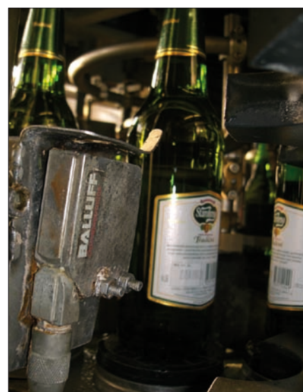
Obr. 3. Difúzní optický snímač pro kontrolu přítomnosti etikety na lahvi
