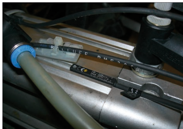
Obr. 6. Snímač BMF 303 pro snímání polohy pneumatického pohonu
