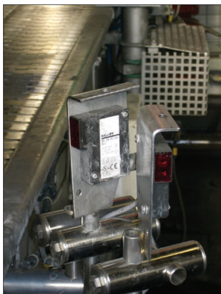
Obr. 1. Optický snímač BOS 35K na dopravníku stáček piva do sudů
