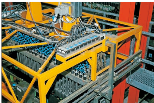
Obr. 4. Na třídící lince jsou použity modulárně koncipované ventilové terminály CPX/MPA s napájecími deskami za každým spojovacím blokem, které dovolují rychlé přivedení tlaku a odvětrání
