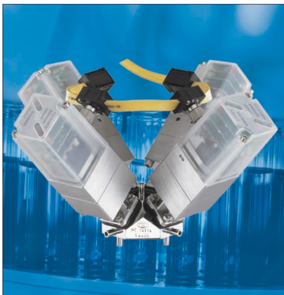
Obr. 3. Blok TOC s pohonem 651 (při sepnutí automatického měřicího místa v rámci systému se přes blok připojí např. čtyři měřicí místa k měřicímu zařízení; měří se ve stanoveném rytmu; proudění médií je automaticky plně řízeno blokem Multiport, jehož pohony jsou připojeny k centrálnímu řízení PLC)
