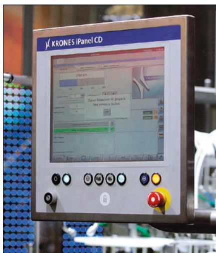
Obr. 2. Operátorský panel od firmy B&R v provedení pro společnost Krones
