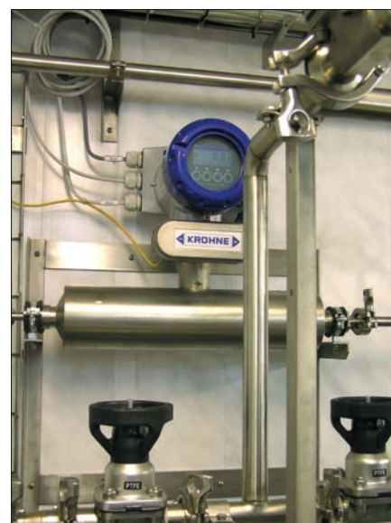
Obr. 2. Hmotnostní průtokoměr Optimass 7300 v lince na výrobu likérů (zdroj: Krohne)
