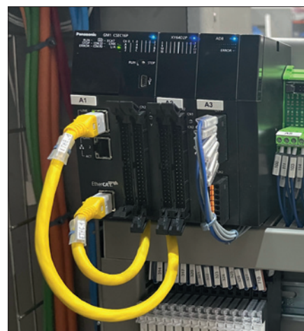
Obr. 3. Řízení polohy a pohybu zajišťuje systém GM1 od firmy Panasonic Industry
