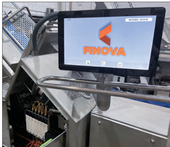
Obr. 5. Pro obsluhu stroje je určen panel HM vhodný do prostředí s velkými požadavky na hygienu
