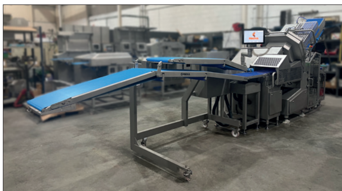
Obr. 1. Nářezový stroj Automatic SliceFil-655 od španělské firmy Finova
