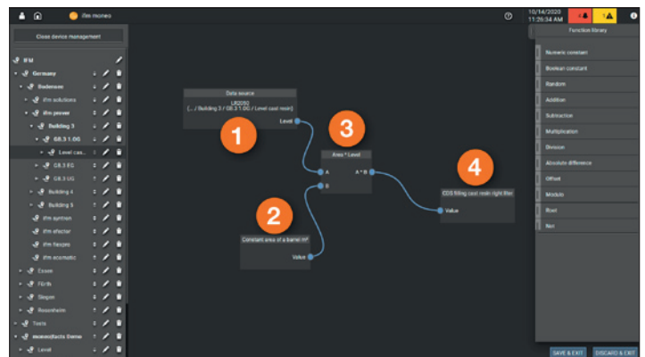
Obr. 3. Dataflow Modeler umožňuje např. zavádět nové proměnné výpočtem z několika měřících bodů
