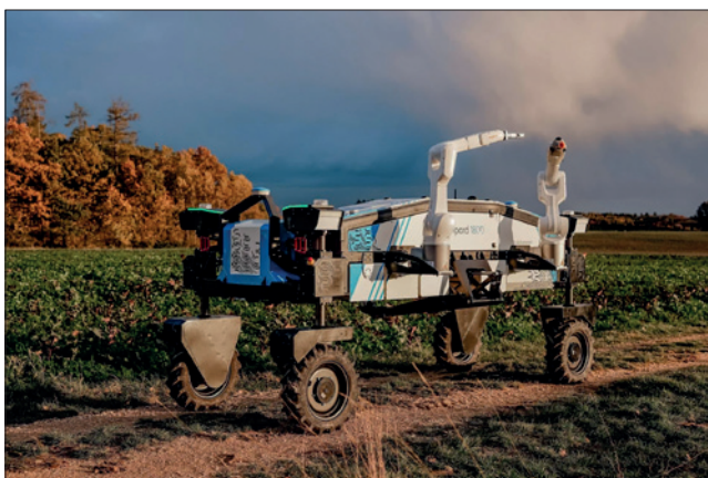
Obr. 1. Mobilní platforma Tipard 1800 (Digital Workbench) a dva roboty Agilus (KUKA) určené pro sklizeň jablek
