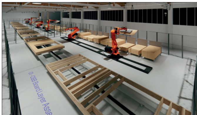
Obr. 2. Výrobní linka na dřevohybridní stavební panely v závodě Gropypus Production Richen
