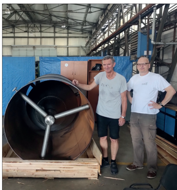
Obr. 2. Dodaný průtokoměr má jmenovitou světlost DN 1400 (foto: HENNLICH s. r. o.)
