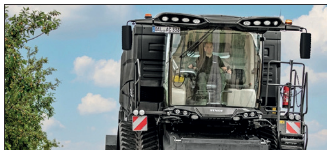
Obr. 2. Pohled na kabinu – varianta bez řídicího sloupku umožňuje výborný výhled z vozidla
