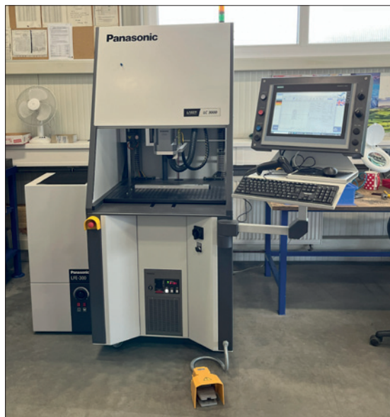
Obr. 3. Pracovní stanice laserového značení LC 3000
