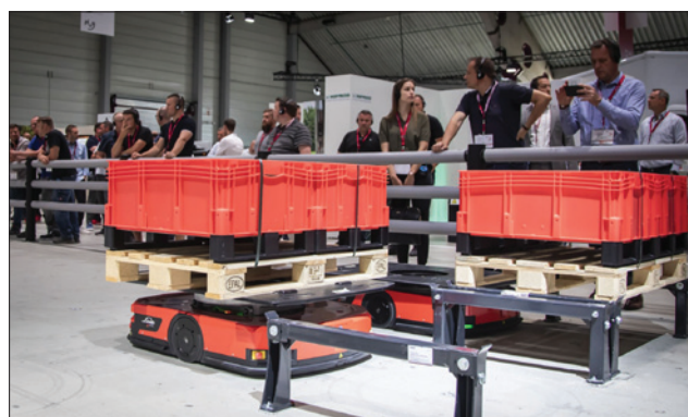
Obr. 2. Nové transportní vozíky Linde C-Matic autonomně projíždějí sklady nebo výrobními prostory; náklad nebo palety lze nabírat pomocí přepravního stolu, pod nějž vozík zajede, nebo pomocí pevně namontované adaptérové desky
