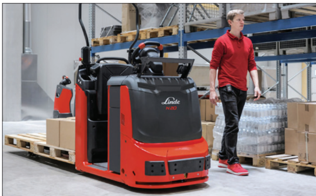
Obr. 3. Nové poloautomatické vychystávací vozíky Linde N20 SA a N20 C SA nabízejí dva jízdní režimy, ve kterých vozidla automaticky následují obsluhu nebo jsou řízena samostatně dálkovým ovladačem, takže obsluha může jít vedle vozíku či za vozíkem
