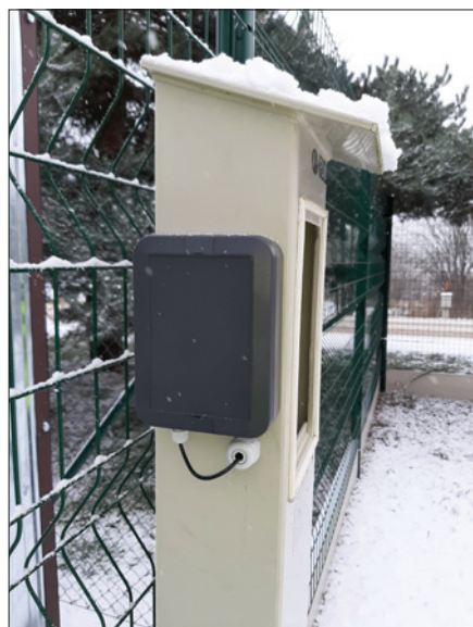
Obr. 1. Bezobslužný měřicí modul katodické ochrany s bezdrátovým přenosem do IoT instalovaný v terénu
