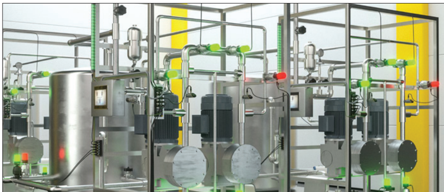
Obr. 6. Ve farmaceutické výrobě se stále častěji používají modulární výrobní linky, jejichž moduly mají samostatný, předem otestovaný řídicí systém
