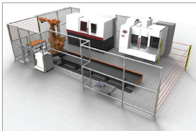
Obr. 3. Virtuální dvojče robotizované obráběcí buňky v Ústavu výrobních strojů, systémů a robotiky FSI VUT v Brně
