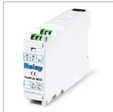
Obr. 3. Převodník PadPuls umožňuje připojit na M-Bus měřiče s pulzním výstupem S0
