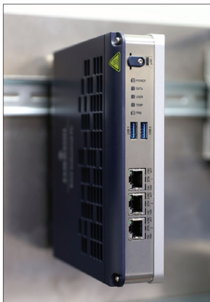
Obr. 1. Řídicí jednotka PACSystems RX3i CPL410 vybavená softwarem PACEdge je určena pro zpracování a analýzu dat ve vrstvě edge
