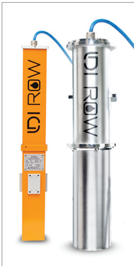
Obr. 1. Snímač ROW (Remote Optical Watcher) je bezkontaktní přístroj k detekci ropných látek na vodní hladině (na obrázku je standardní hliníková verze a provedení z korozivzdorné oceli do prostředí s nebezpečím výbuchu)
