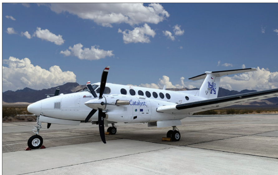
Obr. 1. Létající laboratoř pro zkoušky motoru Catalyst (foto: ČVUT)
