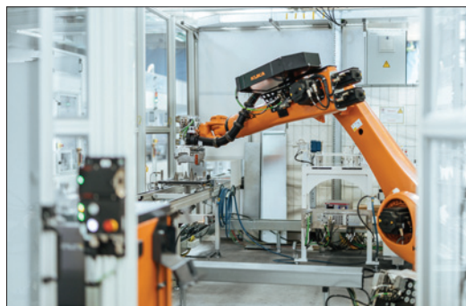
Obr 2. Nejdříve montáž, pak kontrola: robot Kuka KR Quantec kontroluje střídače elektromobilu
