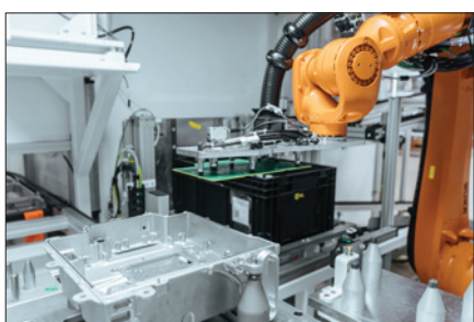
Obr 1. Precizní montáž: KR Cybertech vkládá vnitřní elektronické prvky do krytu střídače elektromobilu
