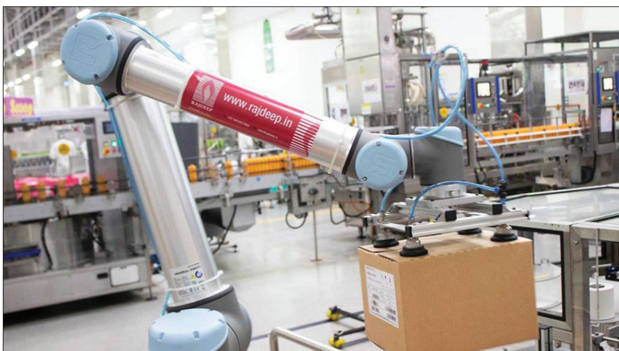
Obr. 2. Ve výrobním závodě společnosti L'Oréal se zabalenými krabicemi manipuluje kolaborativní robot od Universal Robots (foto: Universal Robots)
