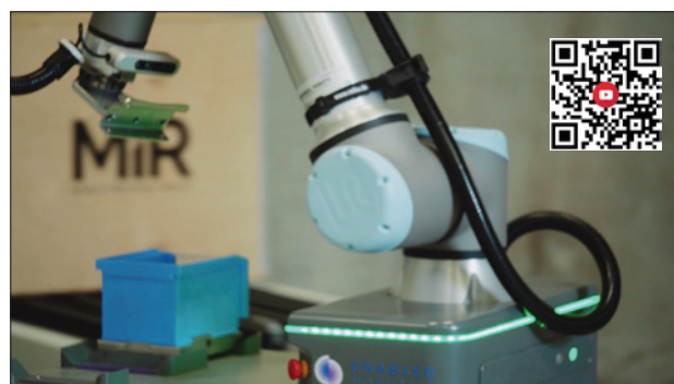
Obr. 3. Kolaborativní robotické rameno od Universal Robots komunikuje s autonomním mobilním robotem od MiR, čímž zvyšuje rychlost a přesnost expedice objednávek (video: https://youtu.be/_Qns_YC0hto ; zdroj: MIR)
