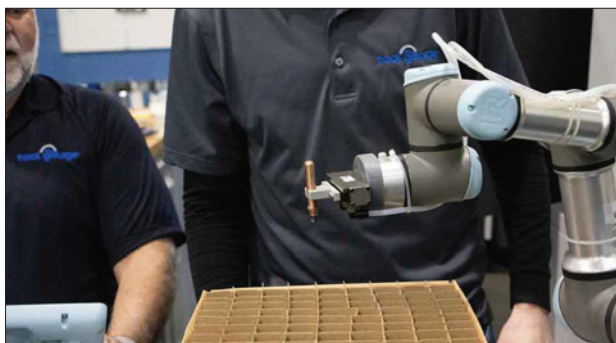
Obr. 1. Robot UR3 od Universal Robots ve firmě Tool Gauge automaticky umísťuje drobné součástky do speciálně vytvarovaných oddílů v krabici (foto: Universal Robots)
