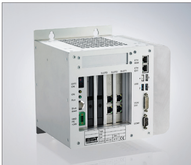
Obr. 2. Častým případem úprav katalogových produktů je náhrada starších počítačů jiných výrobců průmyslovými počítači firmy Beckhoff, které nabízejí velkou odolnost a spolehlivost, dlouhodobou životnost a možnost práce v reálném čase
