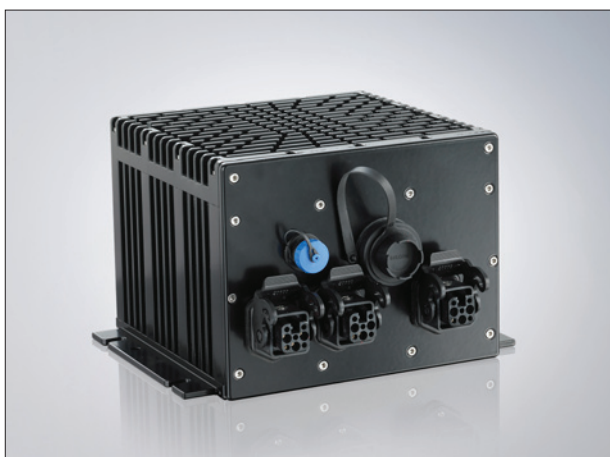
Obr. 1. Průmyslové PC navržené podle požadavků zákazníka, které je vhodné do velmi náročných podmínek a venkovního prostředí (např. pro zemědělské stroje)
